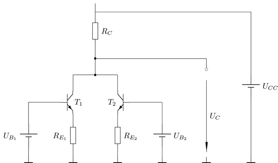
Die beiden Transistoren seien identisch und werden beide im Bereich der Vorwärtsverstärkung betrieben ( $U_{BE} = 0.5 \text{ V}$ ,  $\beta_F \approx 100$ ). Für die Spannungen gelte:  $U_{CC} = 5 \text{ V}$ ,  $U_{B1} = 2.5 \text{ V}$ ,  $U_{B2} = 1.5 \text{ V}$ . Die Widerstände seien wie folgt dimensioniert:  $R_C = 100 \text{ k}\Omega$ ,  $R_{E1} = 1 \text{ M}\Omega$ ,  $R_{E2} = 333 \text{ k}\Omega$ .
