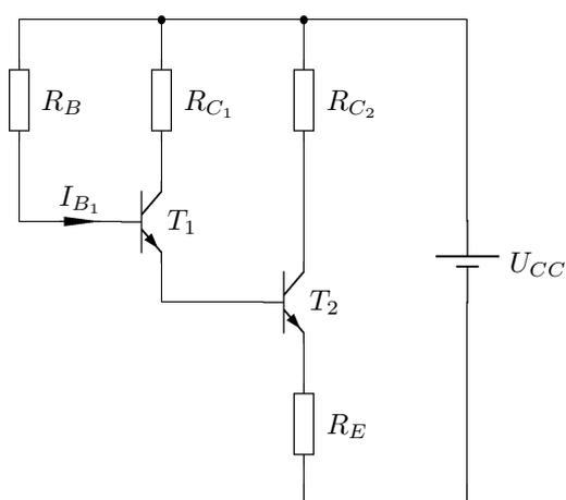
Die beiden Transistoren seien identisch und werden beide im Bereich der Vorwärtsverstärkung betrieben ( $U_{BE} = 0.5 \text{ V}$ ,  $\beta_F \approx 100$ ). Die Betriebsspannung betrage  $U_{CC} = 5 \text{ V}$ . Die Widerstände seien wie folgt dimensioniert:  $R_B = 1 \text{ M}\Omega$ ,  $R_{C1} = 5 \text{ k}\Omega$ ,  $R_{C2} = 75 \Omega$ ,  $R_E = 100 \Omega$ .
