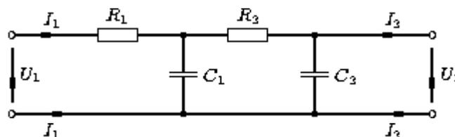
Die Bauteile seien wie folgt dimensioniert:  $R_1 = 10\text{k}\Omega$ ,  $R_2 = 1\text{M}\Omega$ ,  $C_1 = 2\text{nF}$ ,  $C_2 = 0,5\mu\text{F}$ .
