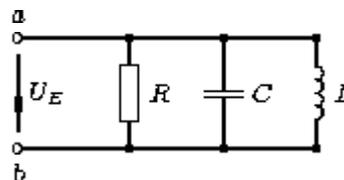
Die Spannung über den Klemmen  $a$  und  $b$  sei  $U_E = U_0 \cdot e^{j(\omega t + \varphi)}$ . Die Bauteile seien wie folgt dimensioniert:  $R = 1\text{k}\Omega$ ,  $C = 8\text{nF}$ ,  $L = 2\text{mH}$ .
