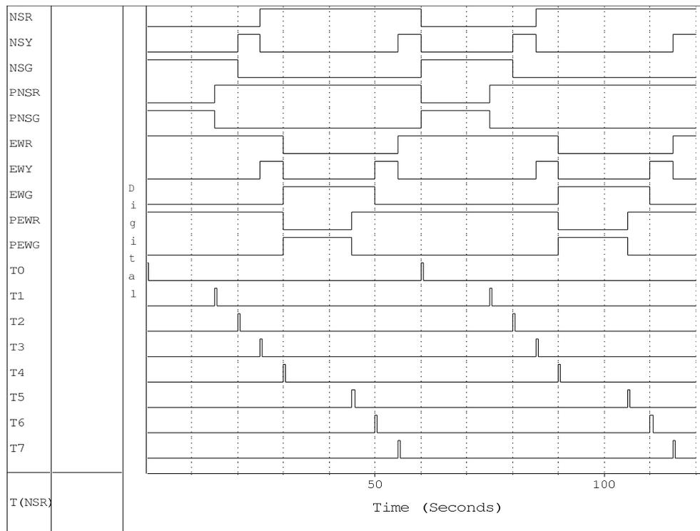
Dabei bezeichnen NSR, NSY und NSG die Lichter der Ampeln in Nord-Süd-Richtung, sowie EWR, EWY und EWG die Lichter der Ampeln in Ost-West-Richtung. Ein vorangestelltes P markiert die entsprechenden Fußgängersignale. Um ein Umschalten der Fußgängerampeln vor dem Umschalten der zugehörigen Hauptampeln zu ermöglichen, werden zwei weitere Taktsignale nach 15 bzw. 45 Sekunden benötigt.
