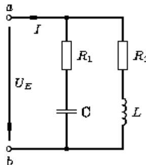
Die Spannung über den Klemmen  $a$  und  $b$  sei  $U_E = U_0 \cdot e^{j(\omega t + \varphi)}$ .
