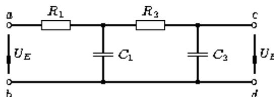
das zwischen den Klemmen  $a$  und  $b$  mit der Spannung  $U_E = U_0 \cdot e^{j\omega t}$  beaufschlagt wird. Wie berechnet sich die Spannung  $U_B$  an den Klemmen  $c$  und  $d$  in Abhängigkeit von der Kreisfrequenz  $\omega$ ?
