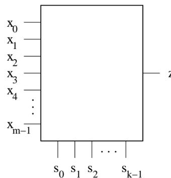
Die Auswahl des Eingangs  $x_i \mid i \in \{0, \dots, m-1\}$  soll durch Belegung der Steuerleitungen mit Werten aus  $\{0, 1\}$  so erfolgen, daß sich der Index  $i$  ergibt zu
