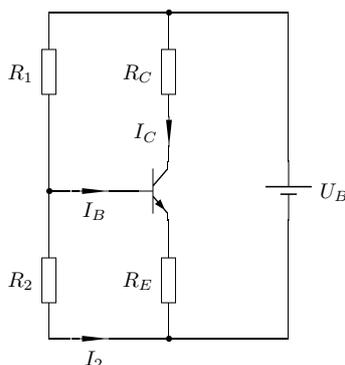
Der Transistor wird im Bereich der Vorwärtsverstärkung betrieben. Im Arbeitspunkt soll gelten:  $U_B = 10\text{ V}$ ,  $U_{BE} = 0.7\text{ V}$ ,  $U_{RE} = 0.5\text{ V}$ ,  $U_{CE} = 5\text{ V}$ ,  $\beta_F = 100$ ,  $I_2 = 10 I_B$ ,  $I_C = 1\text{ mA}$ .
