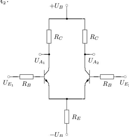
Der Differenzverstärker ist aus zwei identischen Transistoren aufgebaut, die beide im Bereich der Vorwärtsverstärkung betrieben werden ( $\beta_F = 100$ ,  $U_{BE} = 0.7\text{ V}$ ). Die Betriebsspannung betrage  $U_B = 5\text{ V}$ .
