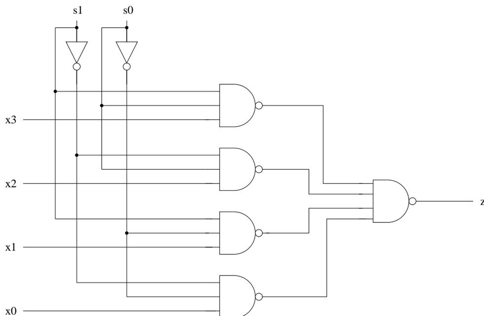
Bei Realisierung in CMOS-Logik werden für jeden Inverter zwei Transistoren und für jedes NAND-Gatter zwei Transistoren pro Eingang benötigt. Also sind in diesem Fall
