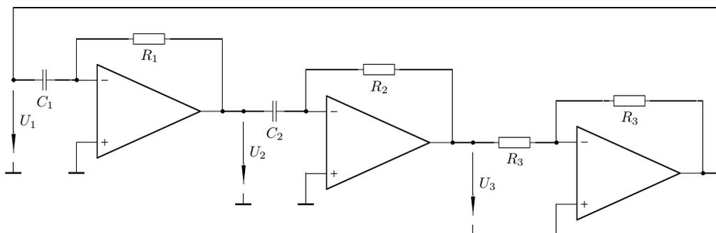
Finden Sie heraus, ob es sich bei dieser Schaltung um einen Oszillator handelt oder nicht. Berechnen Sie dazu die Spannung  $U_1$  in Abhängigkeit von  $R_1$ ,  $R_2$ ,  $C_1$ ,  $C_2$ .
