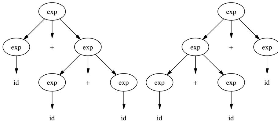
Links wird *shift* vor *reduce* benutzt, rechts *reduce* vor *shift*. Hier ist die Heuristik von Happy unpassend! Lösung: Entweder wieder die Grammatik modifizieren oder eine neue Parserdeklaration einfügen:
