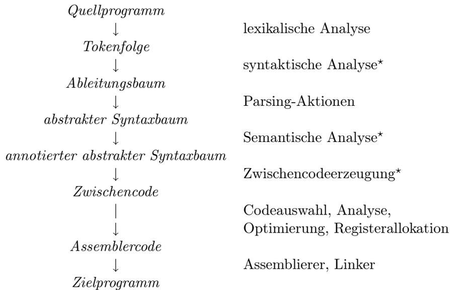
Phasenübergreifend existiert bei \* die **Symboltabelle**, eine zentrale Datenstruktur des Compilers. Die einzelnen **Phasen** des Übersetzungsvorgangs:
